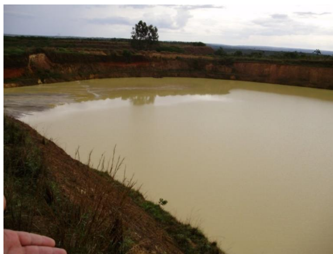
Figura 5. O Corpo B acumula água utilizada no balanço hídrico da produção minerária. Em seguida, esse efluente é aplicado nas atividades de tratamento dos minérios retirados do corpo C.
