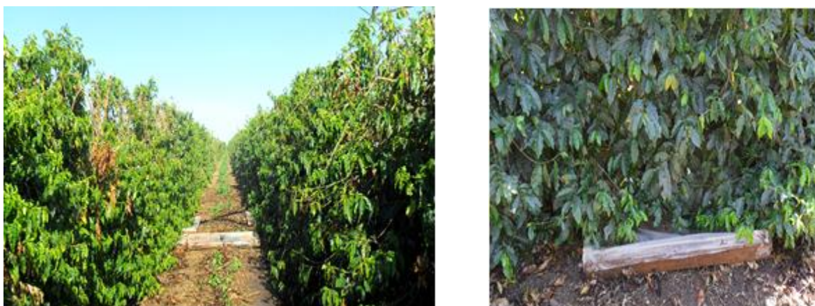
Figura 1. Estruturas coletoras em campo, após passagem do pivô central (esquerda) e detalhe de uma das estruturas posicionada sob o dossel (direita).
